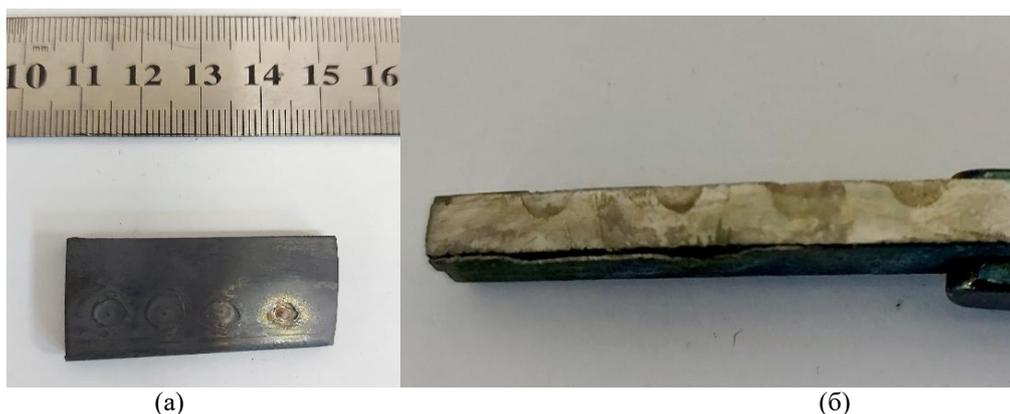
Рис. 2. Образцы после облучения: вид сверху (а) и поперечный шлиф (б)
