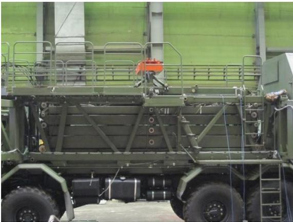
Рис. 1. Испытания подъемников пантографного типа
