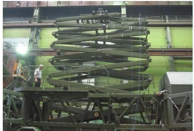
Рис. 2. Испытания подъемников пантографного типа
