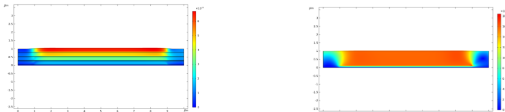
Рис. 3. Результат расчета деформации пьезодвигателей при опоре на подложку
