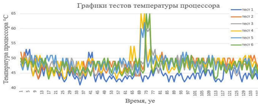
Рис. 2. Результаты снятия температуры при охлаждении встроенным кулером
