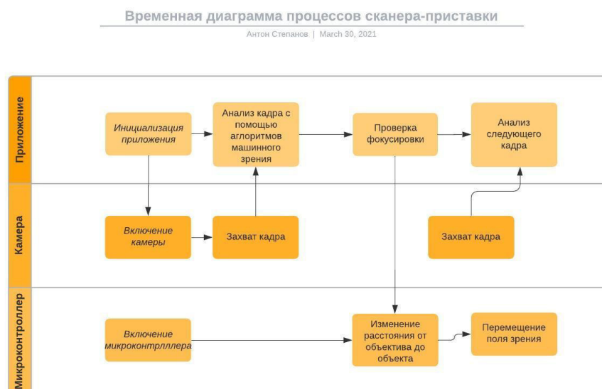
Рис. 2. Функциональная диаграмма работы сканера-приставки
