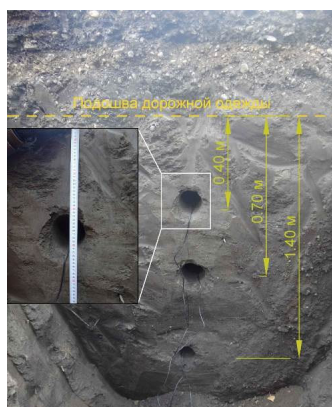
Рис. 3. Общий вид схемы размещения датчиков на экспериментальном участке №2 ПК 12+97
