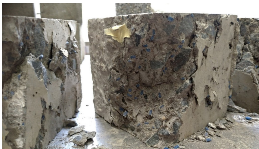
Рис. 2 Образцы тяжелого бетона с применением пластиковых отходов после испытания по прочности на сжатие
