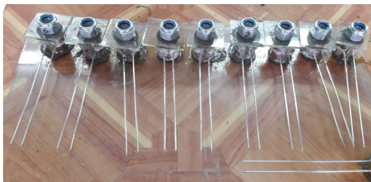
Рис. 1. Кольца Ле Шателье, заполненные цементным тестом нормальной густоты контрольного состава и с ориентированными ОК
