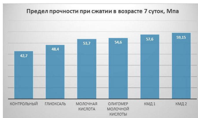
Рис. 1. Прочность бетона с добавками в возрасте 7 суток
