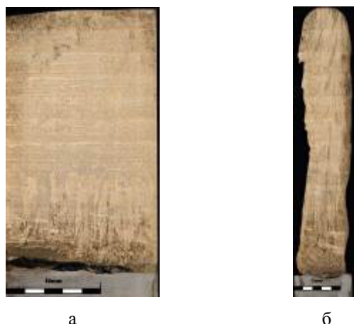
Рис. 2. Структура напечатанной алюминиевой бронзы \text{Cu-9 ат. \% Al - 5,5 ат. \% Si - 0,9 ат. \% Mn} в продольном (а) и поперечном (б) сечениях
