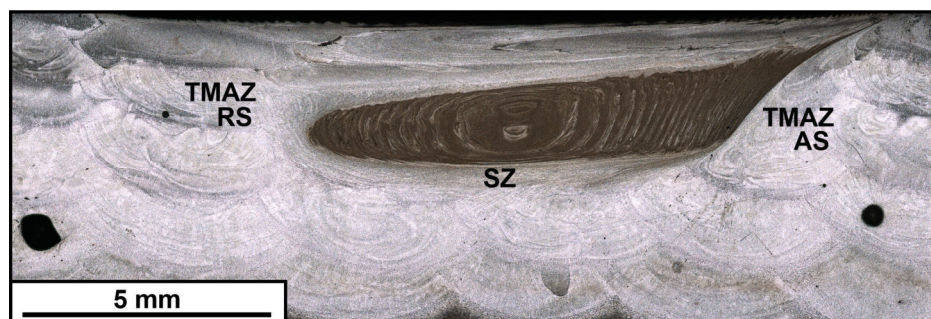
Рис. 1. Макроструктура зоны обработки аддитивно-полученного образца сплава АМг5
