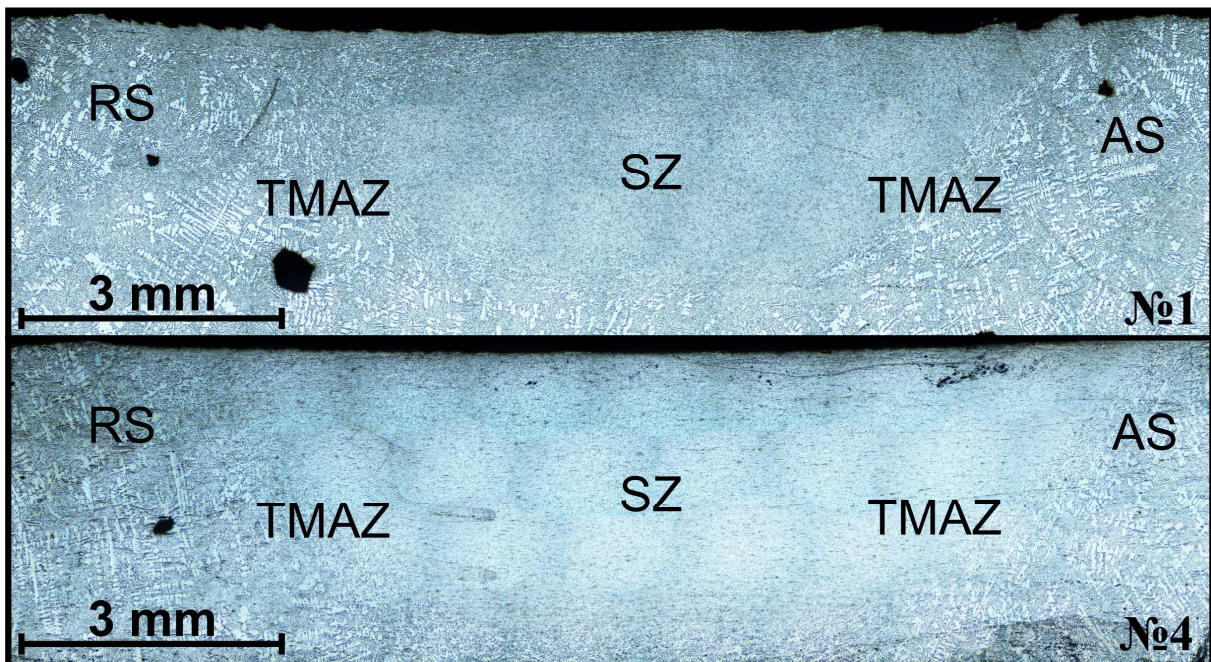
Рис. 2. Структура зоны обработки после 1-го и 4-х проходов инструментом (SZ - зона перемешивания, TMAZ - зона термомеханического влияния, AS - наступающая сторона, RS - отступающая сторона)
