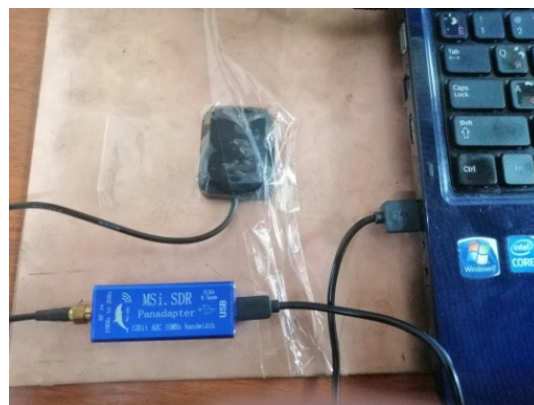
Рис. 2. GPS антенна и MSI.SDR Panadapter
