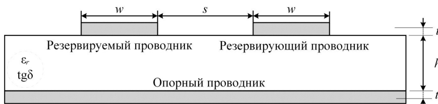
Рис. 2. Поперечное сечение МПЛ с однократным МР
