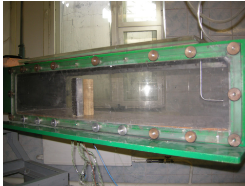
Рис. 2. Общий вид расположения моделей относительно ветрового потока: слева – модель-препятствие «1»; справа - испытываемая нагреваемая модель «2»
