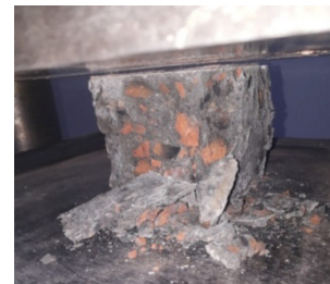
Рис. 3. Испытание бетонного образца на сжатие
