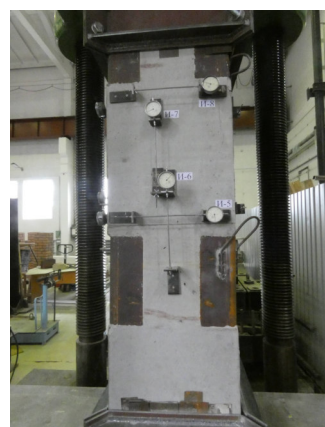
Рис. 1. Общий вид испытания стыка ж/б колонн с клиновидным зазором в 1.5 мм: а) сторона А; б) сторона Б
