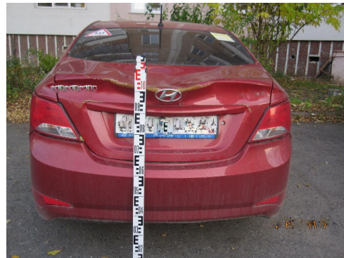
Рис. 4. Повреждение кузовных элементов автомобиля в результате падения снежных масс
