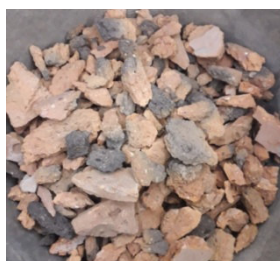
Рис. 2. Продукты переработки керамического кирпичного боя
