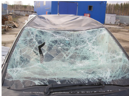
Рис. 3. Повреждение кузовных элементов автомобиля в результате падения снежных масс
