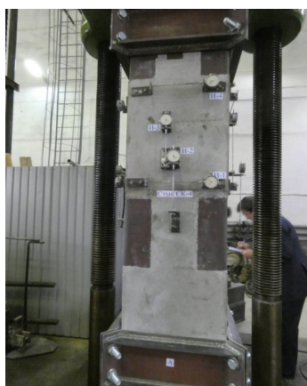
Рис. 1. Общий вид испытания стыка ж/б колонн с клиновидным зазором в 1.5 мм: а) сторона А; б) сторона Б
