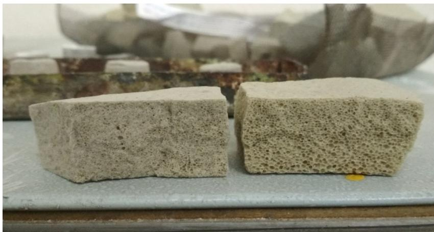
Рис. 1. Влияние количества жидкого стекла на пористость
