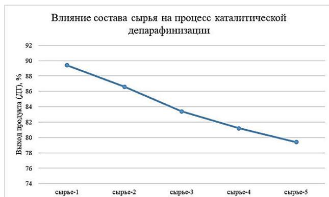
Рис. 6 – Зависимость выхода продукта (ДТ) от состава сырья
