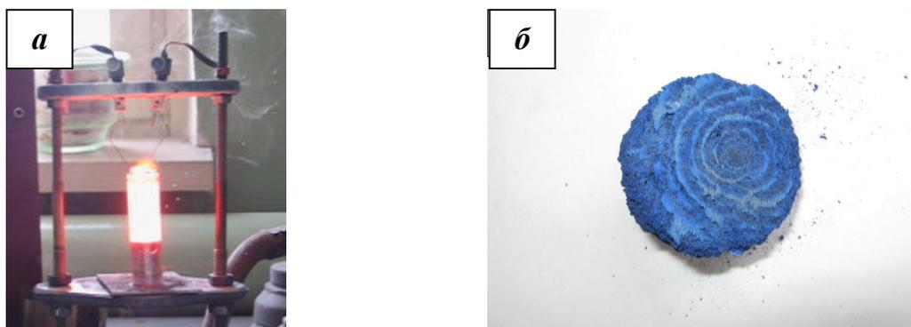
Рис.1. Режим послойного горения ( $\varnothing$  20 мм) - (а), винтообразная спиновая волна ( $\varnothing$  60 мм, поперечный разрез) - (б) пигмента системы  $MgO-ZnO-CoO-Al_2O_3$ .
