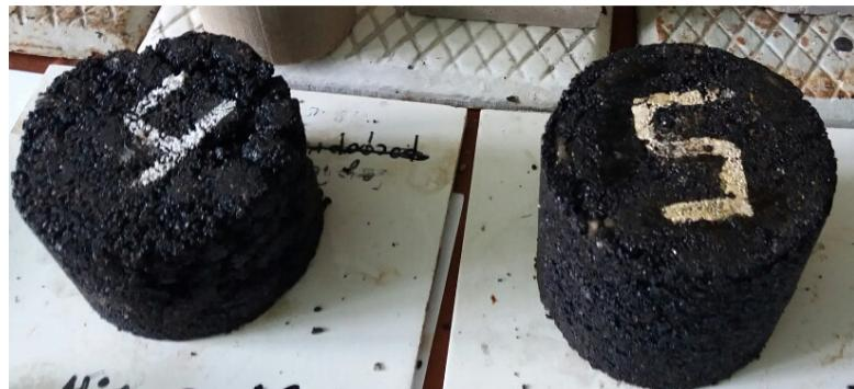
Рис. 2. Мелкозернистый асфальтобетон
