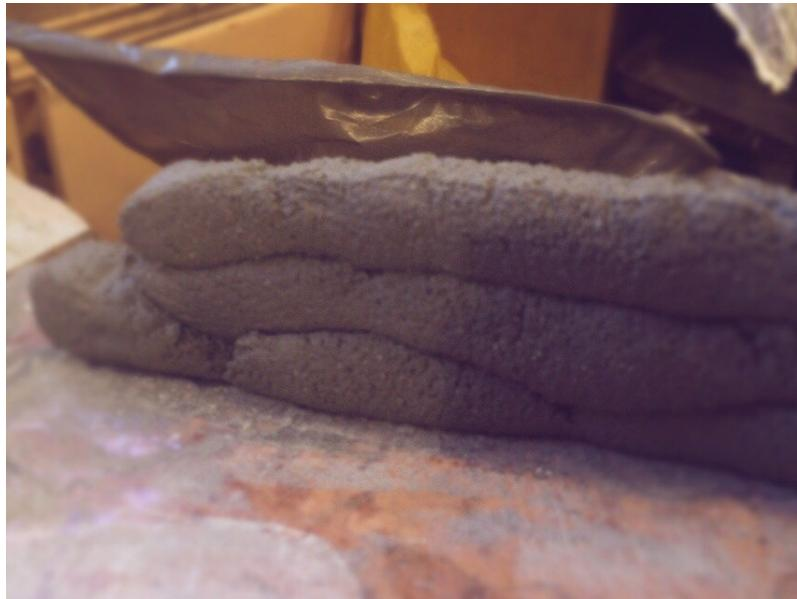
*Рис. 2. Послойное нанесение состава №1 цементно-песчаной смеси методом экструзии.*
