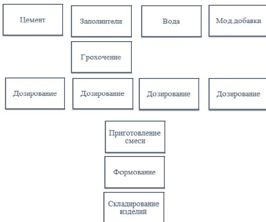
*Рис. 1. Технологическая схема производства изделий с помощью 3D-принтера.*
