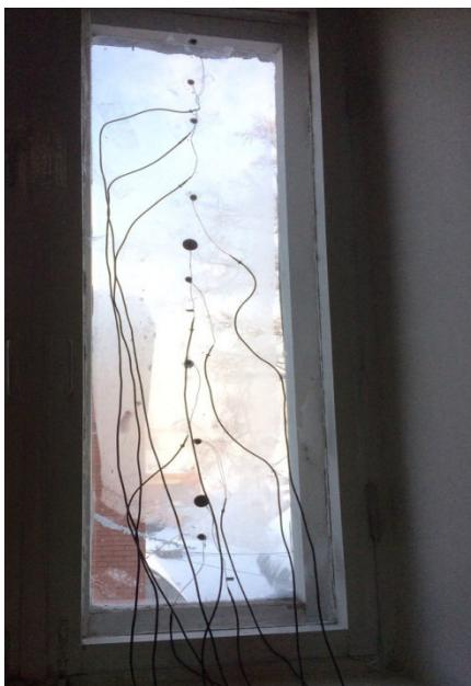
Рис. 1. Схема установки датчиков температуры по поверхности остекления
