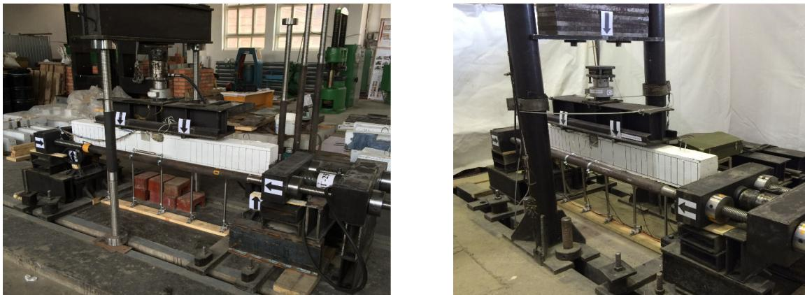
Рис. 2. Стенд при статическом (слева) и кратковременном динамическом(справа) нагружениях с распором на податливых опорах.
