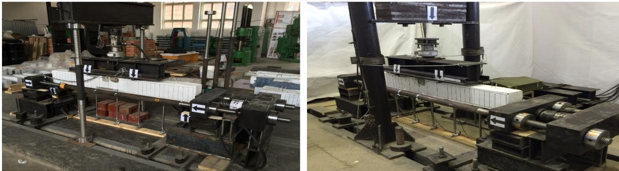
Рис. 3. Стенд при статическом (слева) и кратковременном динамическом(справа) нагружениях с распором.
