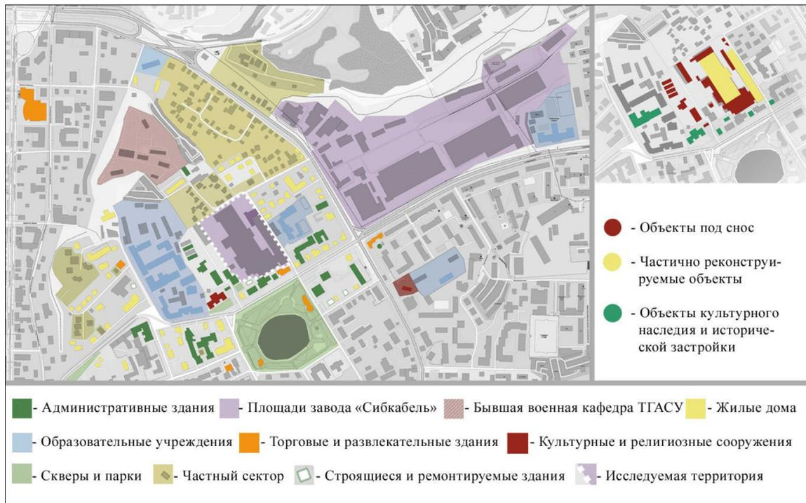
Рис. 1. Опорный план со схемой демонтажа промышленных корпусов и прилегающей территории.
