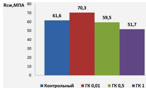
Рис.3. Влияние кристаллического глиоксала на прочность цементного камня в возрасте 28 суток
